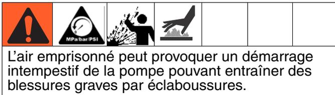
3. Placez une seconde vanne pneumatique (E) en amont de tous les accessoires de la conduite d'air et utilisez-la pour les isoler pendant le nettoyage et la réparation.
